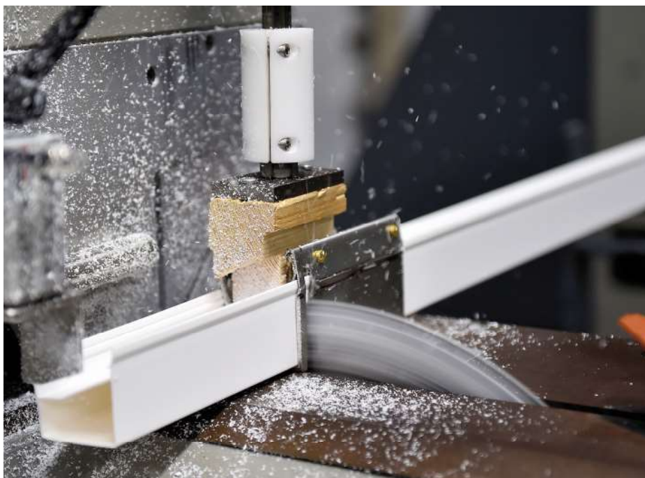
Kapning av profil
